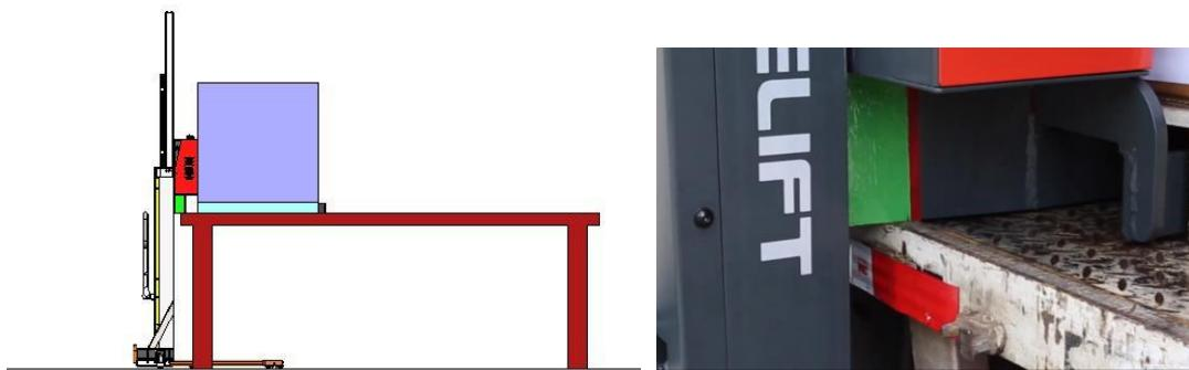
5. Нажатием на кнопку опускания вил, приподнять опорные вилы так, чтобы они оказались в воздухе.
