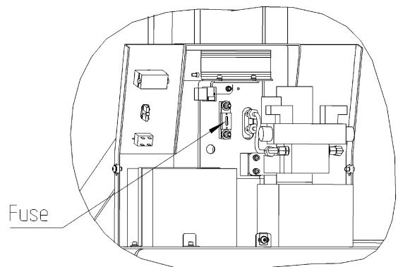
Рис. 14: Расположение предохранителей
