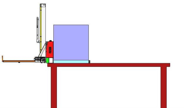
9. Немного приподнять вилы и втолкните штабелер на платформу, чтобы рулевые колеса и нагрузочные ролики касались земли.
