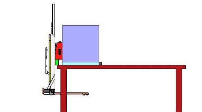
6. Вытащить палец и выдвинуть опорные вилы до упора
