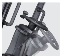
Рулевая колонка с бесступенчато регулируемым углом наклона
