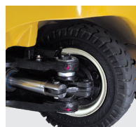
Удлиненная ось с управляемыми колесами для обеспечения лучшей в классе маневренности
