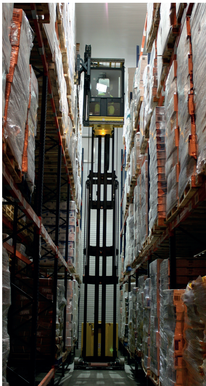
Кабина узкопроходного штабелера для работы на холодном складе.
