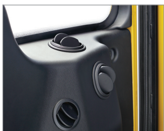
Изолированная дверь с дополнительной вентиляцией для предотвращения запотевания.
